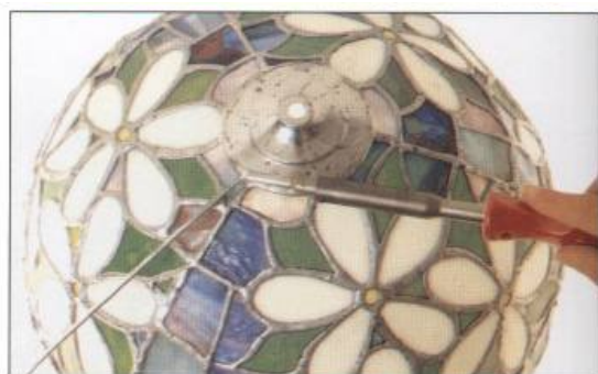
12. Lipiți cu aliaj încheieturile după care aplicați căpăcelul. Acesta trebuie lipit și cositorit.
